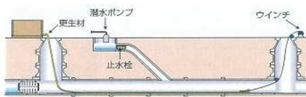
**1 引込工:** 既設管内に更生材を引き込み挿入します。
